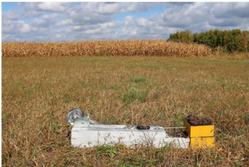
Рис. 1. Установка для дослідження ступеня закріплення абразивної частинки в ґрунті та коефіцієнта внутрішнього тертя ґрунту (дата проведення досліджень 23.09.2018 р., фон – поле після озимої пшениці, Житомирський район, Житомирської області)
