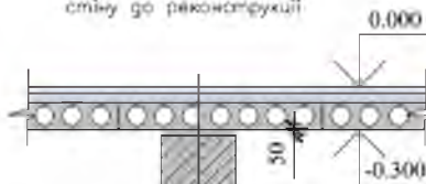
Фундамент під середню стіну до реконструкції
