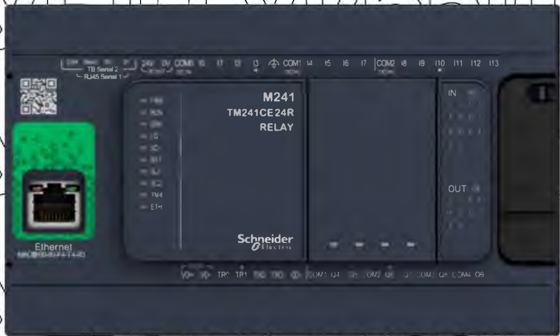
Рис. 3.13. Зовнішній вигляд Shneider Electric ПЛК M241
