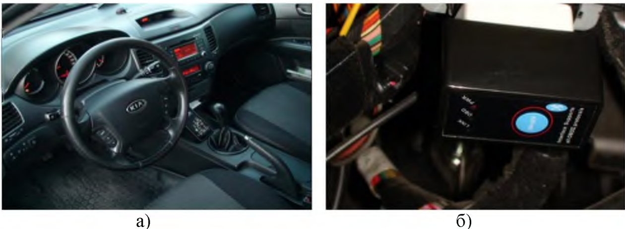
Рис. 1 - Загальний вигляд елементів бортової системи моніторингу параметрів технічного стану і положення для дослідження роботи ТЗ, обладнаного системою впорскування газового палива, в умовах експлуатації засобами ITS: розташованому в автомобілі KIA Magentis 2.0 5МКПП (а); бортовий діагностичний сканер - адаптер Scanmaster ELM327 (б)
