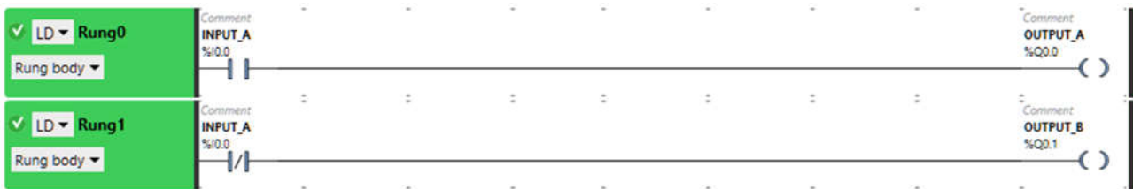
Рис. 2.35. Схема релейно-контактної логіки з використанням логіки перемикачів контурів в програмі Machine Expert – Basic від Schneider Electric
