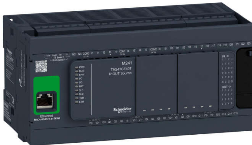
Рис. 6.34. ПЛК Modicon M241 від компанії Schneider Electric
