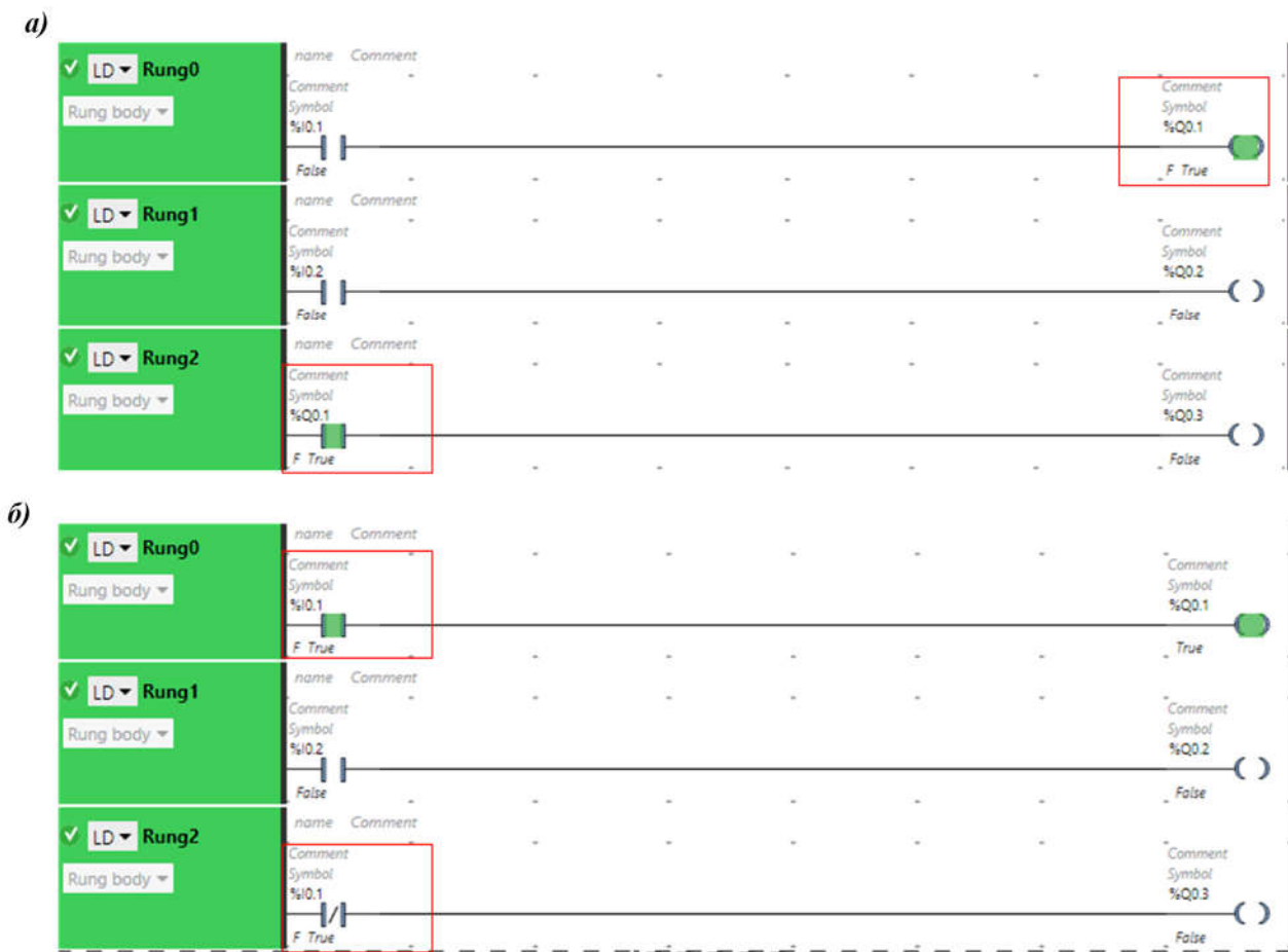
Рис. 3.13. Схема релейно-контактної логіки з форсованим виходом (а), форсованим входом (б)
