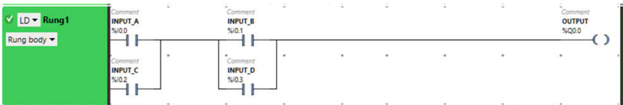
Рис. 2.34. Схема релейно-контактної логіки з використанням логіки з двома гілками елементів АБО (OR) в програмі Machine Expert – Basic від Schneider Electric
