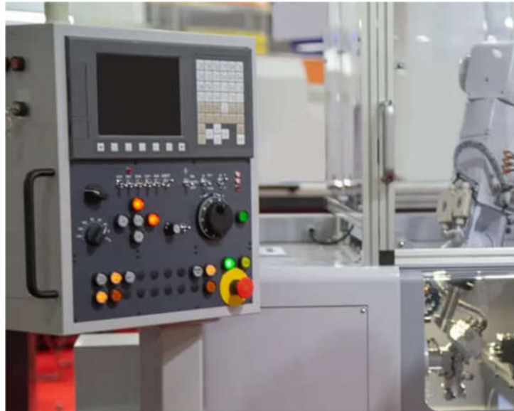
Рис. 6.7. Людино-машинний інтерфейс або графічний термінал
