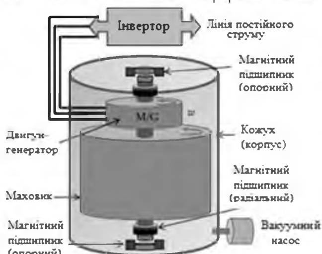
Рис. 2.6 Система накопичення енергії маховика (FESS)
