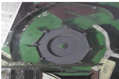
Рис. 3.5. Очісувальний барабан у вигляді восьмигранної призми з вісьмома рядами зубів
