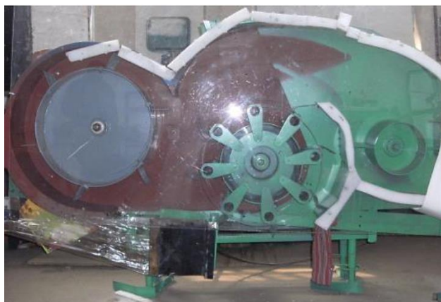
Рис. 3.14. Фотографія лабораторної установки двобарабанного виконання, що використовується для вимірювання швидкості повітряного потоку
