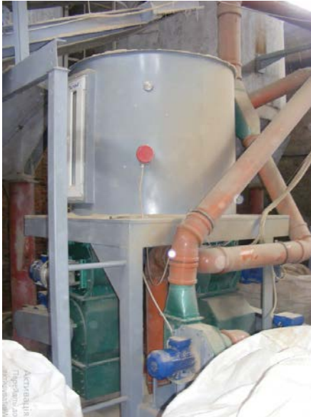
Рис. 4. Накопичувальні бункери сировини після попереднього дроблення.
