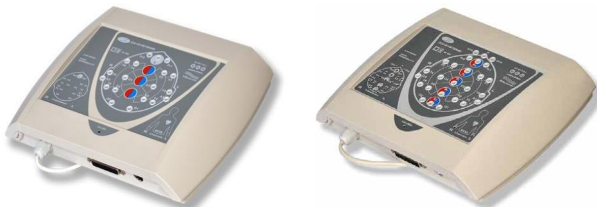
Рисунок 2.4. Вигляд електроенцефалографів: а) RAINTEST 16; б) BRAINTEST
