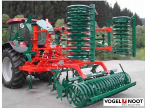
Рис. 2. Комбінована машина VN Terra Mix 500 Hydro для передпосівного обробітку ґрунту
