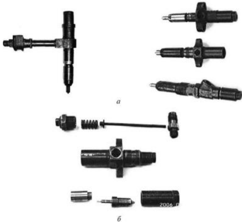
Рис. 4.1. Перевірені форсунки та їх деталі: а) форсунка в зборі; б) складальні деталі форсунки.
