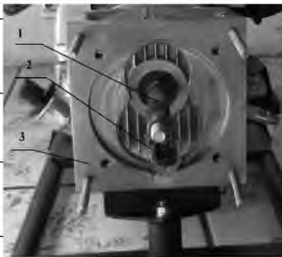
Рис. 4.5 Маховик змінного моменту інерції для двигуна FP10С: 1 - вісь повзуна; 2 - повзун; 3 – корпус
