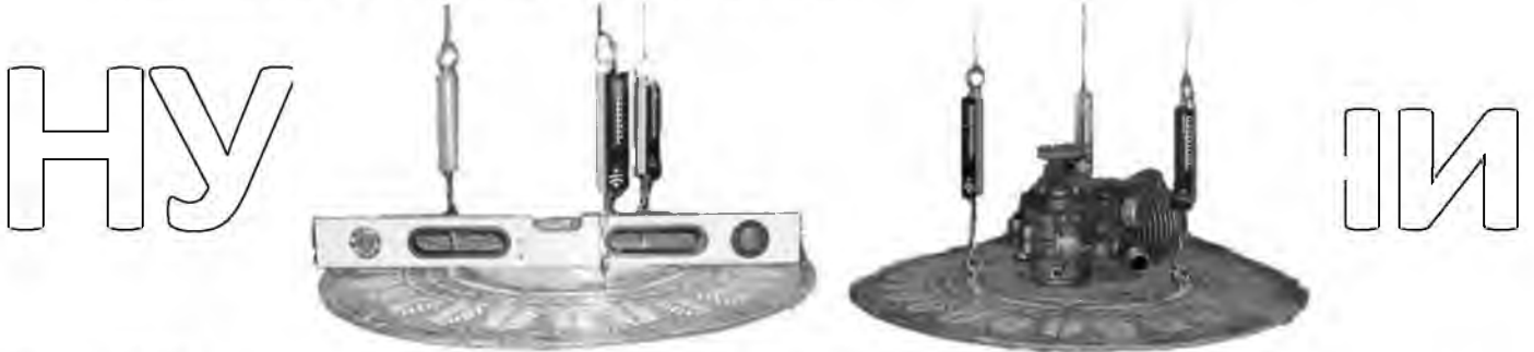
Рис. 3.1 Експериментальне визначення моменту інерції ДВЗ Д-3 методом крутильних коливань
