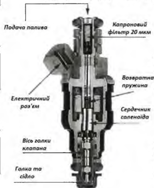
Рисунок. 2.1. Пристрій електромагнітної форсунки
