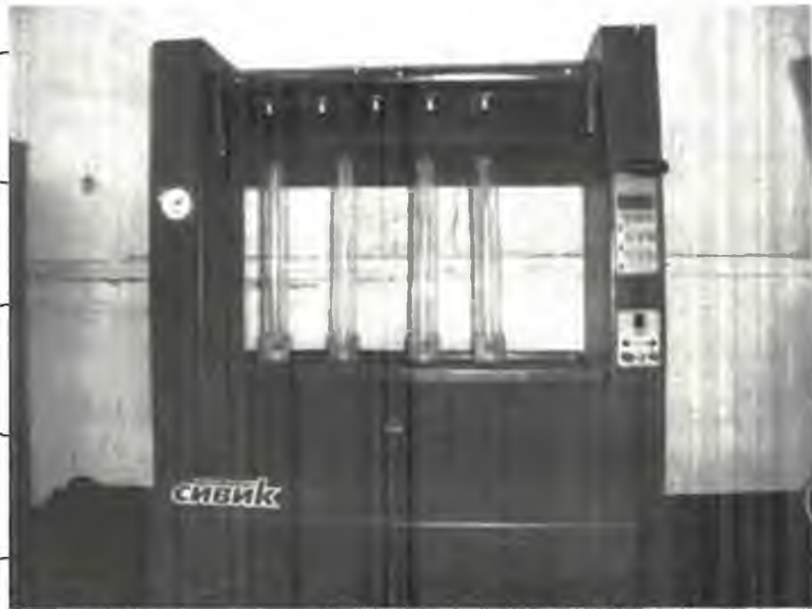
Рисунок 3.1. Стенд для перевірки електромагнітних форсунок Форсаж
