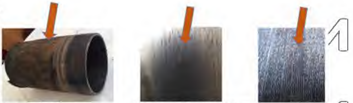
Рис. 1.2. - Дефекти пов'язані із зміною фізико-механичних властивостей матеріалу деталей
