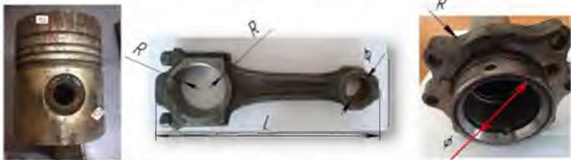
Рис. 1.3. - Дефекти, пов'язані з невідповідністю геометричних розмірів деталей
