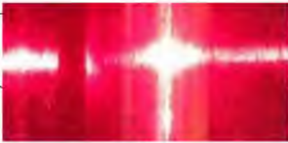
Рис. 4.2 – Зображення лазерної ширини інтенсивності потужності триангуляційного сканера: а – рівень 1 мВт б – рівень 11,2 мВт
