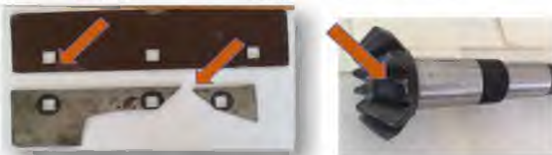
Рис. 1.4. - Дефекти, пов'язані з порушенням цілісності матеріалу деталей
