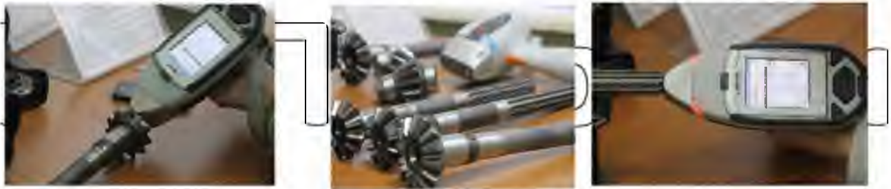
Рис. 4.15 – Контроль хімічного складу матеріалу
