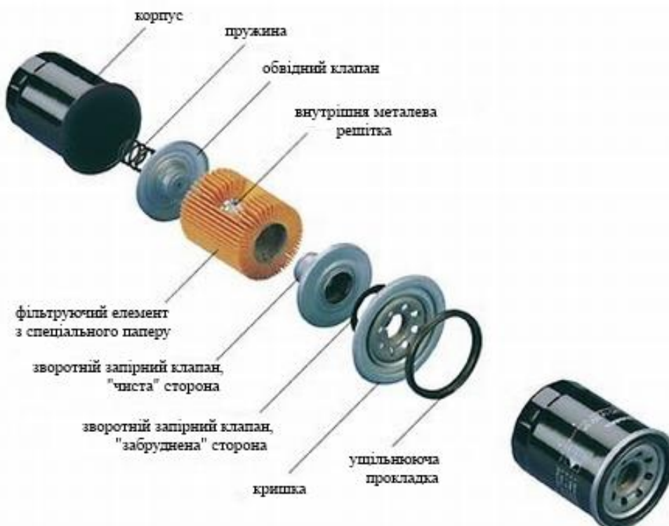
Рис. 1. Будова фільтра для очищення оливи ДВЗ WL 7323
