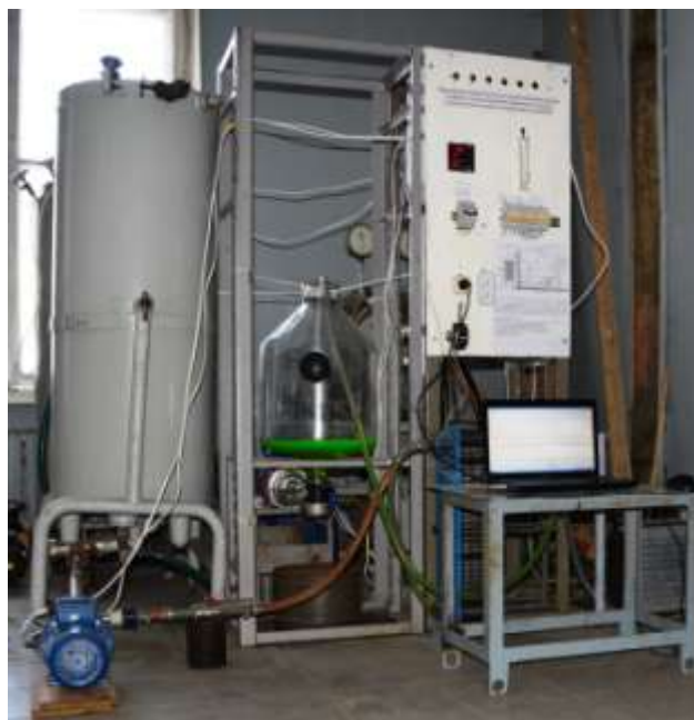
Рис. 1. Экспериментальный образец системы с комплектом энергосберегающего оборудования для охлаждения молока
