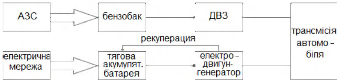
Рис. 2. Функціональна схема гібридного автомобіля з підзарядкою
