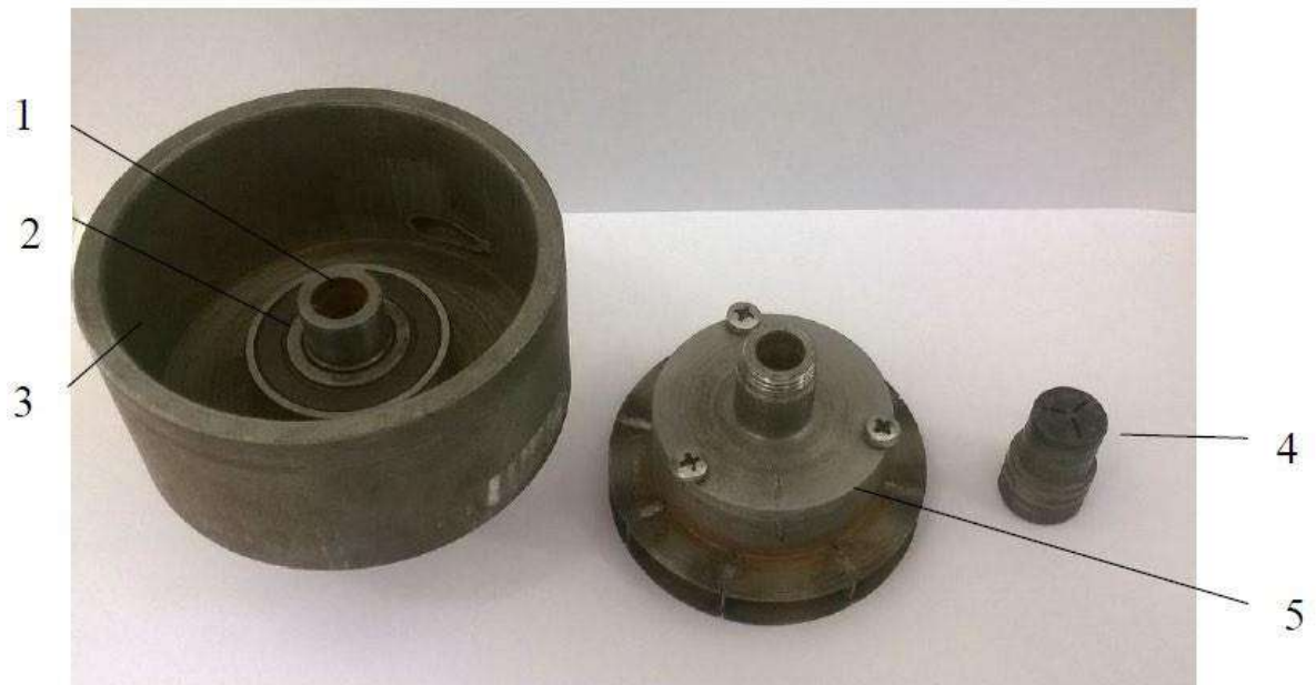
Рис. 3.3. Віялоформуєча насадка гідралічного струменя:
