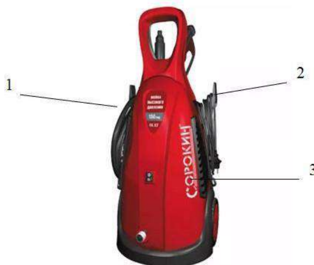
Рис. 1.13. Зовнішній вигляд пересувної мийної установки високого тиску «СОРОКИН 14.17»: 1 - шланг високого тиску, 2 - кабель живлення, 3 - захисний кожух силової установки.
