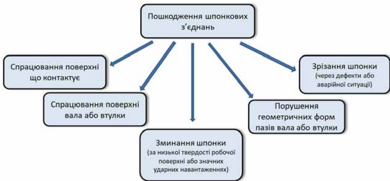
Рис. 2 Характерні види пошкоджень шпонкових з'єднань
