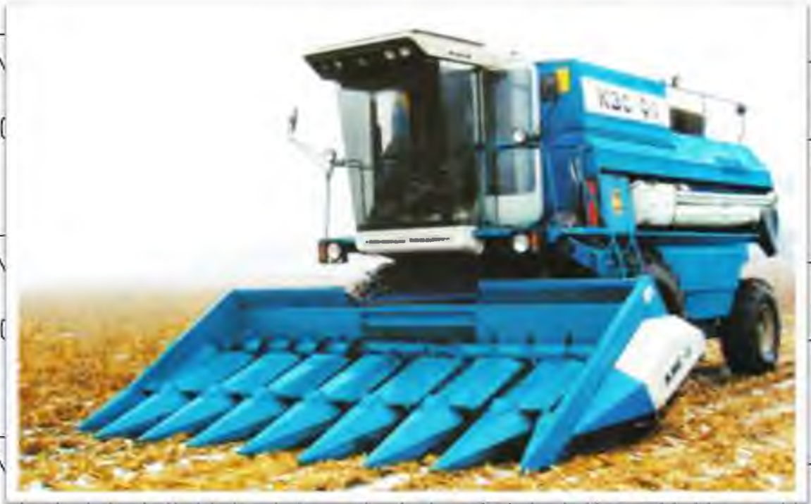
Рис. 2.3. Агрегат для збирання кукурудзи на зерно (КЗС-9-1 «Славутич» + КМС-8).
