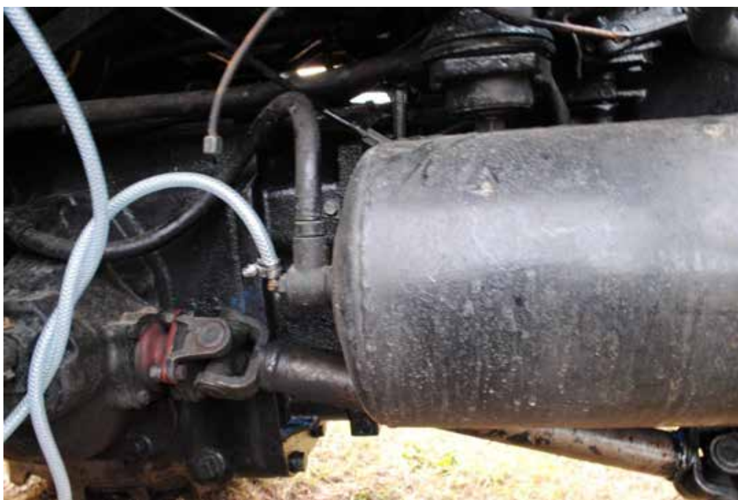
Рисунок 3.6 - З'єднання пневматичної системи змінної дисперсності розпилення з ресивером трактора.
