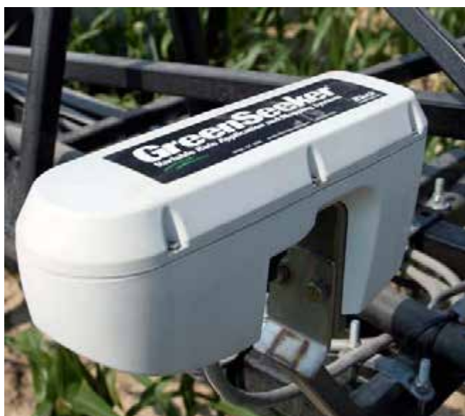
Рис.1.1. Оптичний датчик Green Seeker RT 200
