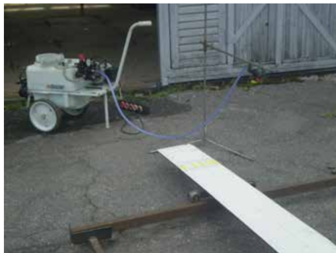
Рис. 3.10– Позиційний обприскувач обладнаний стандартною форсункою Lechler
