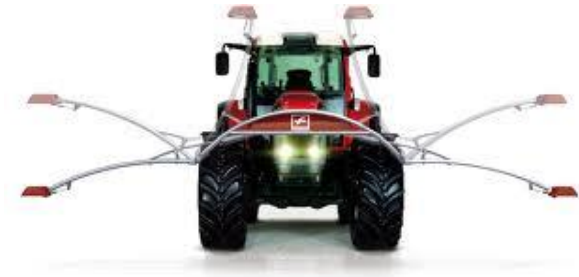
Рис.1.5 Комплекс для диференційованого внесення азотних добрив на основі Fritzmeier ISARIA.
