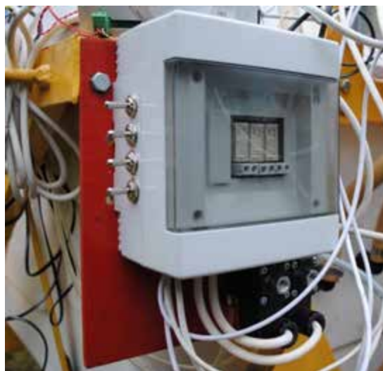
Рисунок 3.2 - Електромагнітний пневмо розподільник 638М-101-А62 фірми Samozzi(Італія) [158] з комутаційною коробкою.
