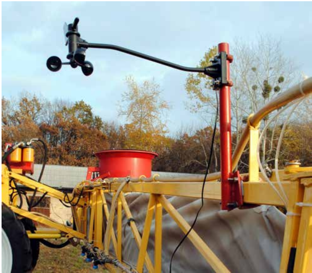
Рисунок 3.3 - Датчик швидкості вітру DAVIS 6410 фірми DAVIS(США).
