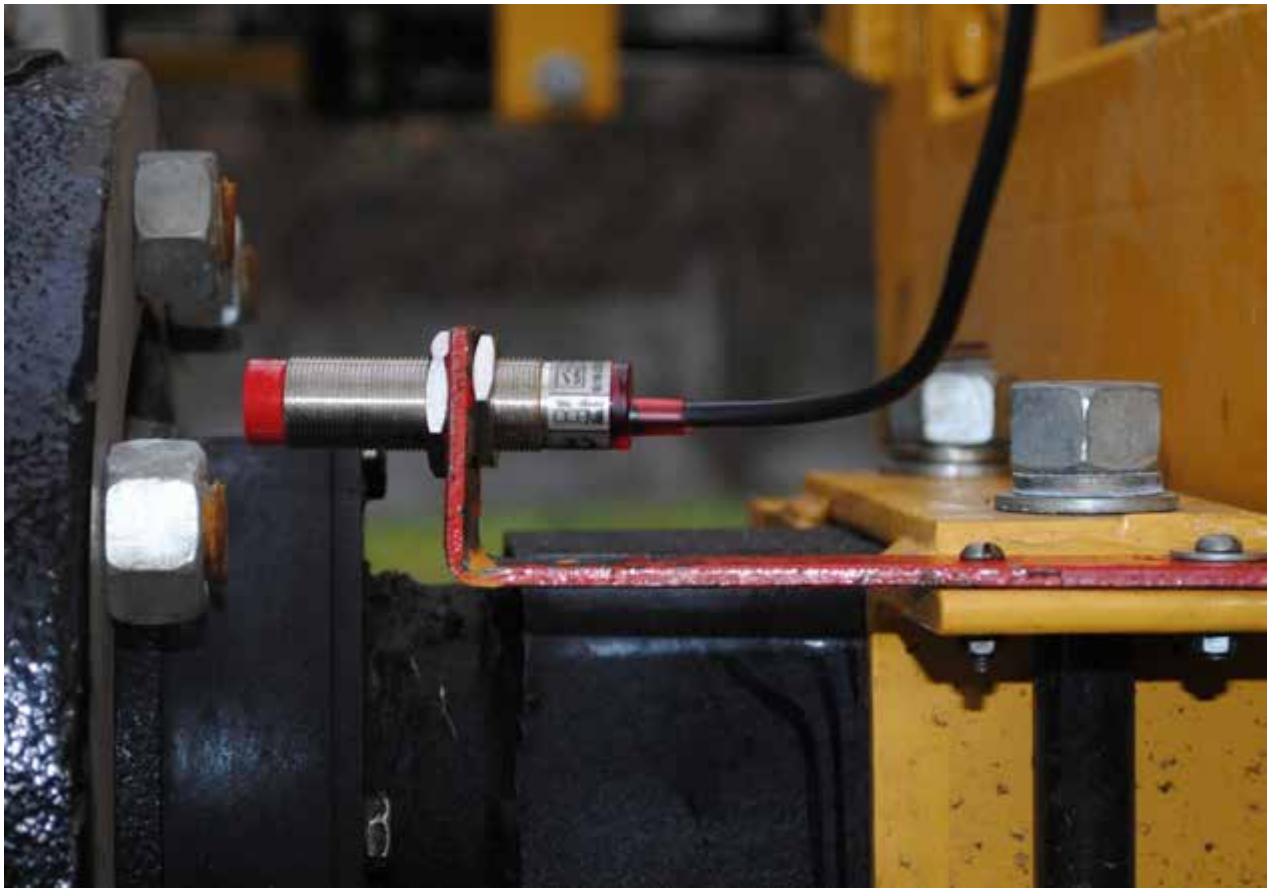
Рисунок 3.7 - Індуктивний детектор швидкості руху агрегата
