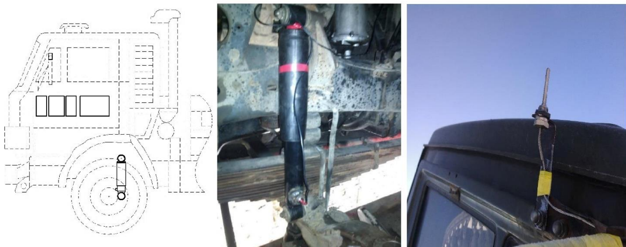
Рисунок 3.1 – Експериментальна установка №1 на базі автомобіля КамАЗ-5320 із встановленими датчиками контролю температури амортизаторної рідини та температури навколишнього повітря
