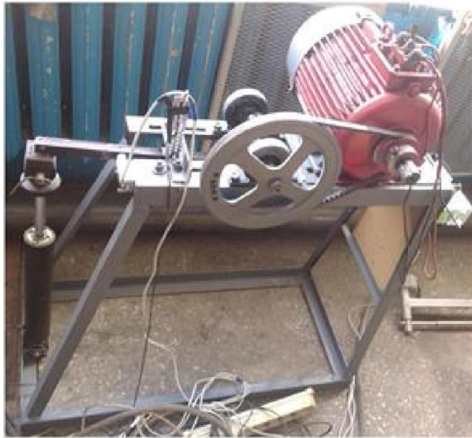
Рисунок 3.2 – Експериментальна установка №2. Стенд для визначення експлуатаційних характеристик амортизаторів
