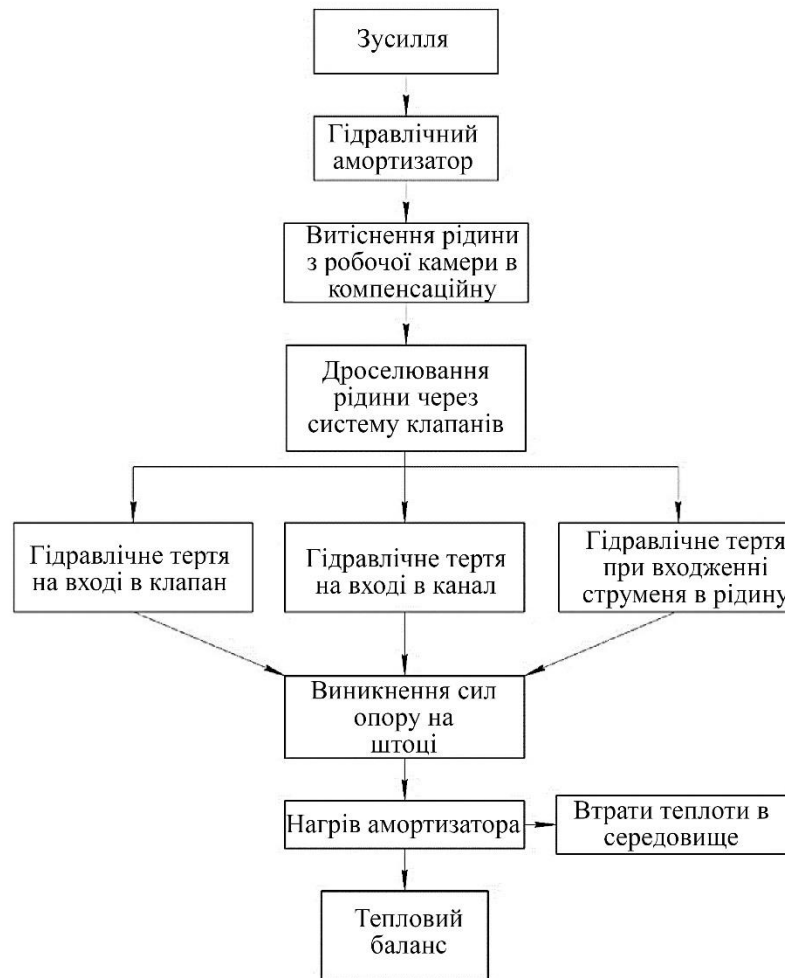
Рисунок 2.2 – Взаємозв’язок процесів, що виникають внаслідок перетворення механічної енергії на теплову під час роботи гідравлічного амортизатора
