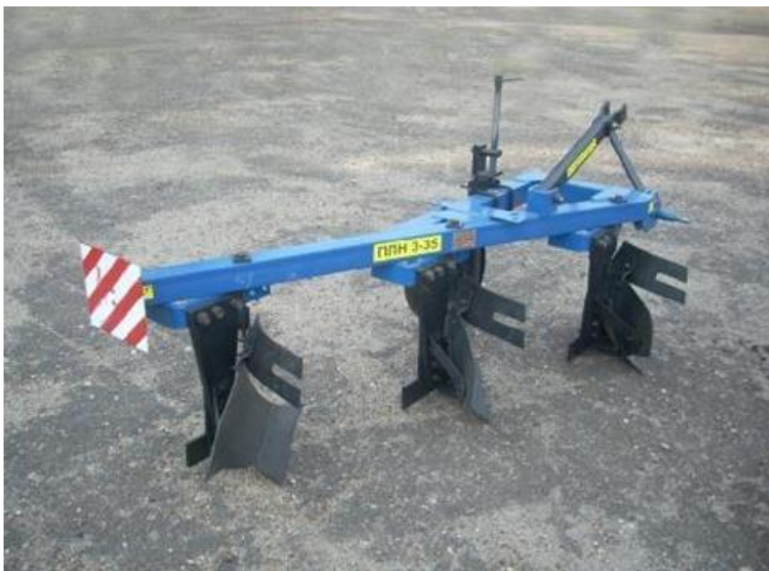
Рис. 2.3 Плуг навісний трьохкорпусний ПЛН-3-35 (вид ззаду праворуч).
