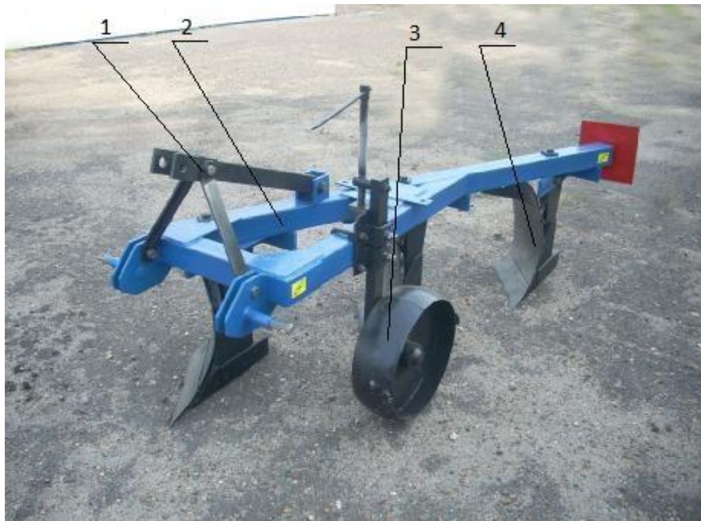
Рис. 2.2 Плуг навісний трьохкорпусний ПЛН-3-35 (вид спереду зліва). 1 – навісний пристрій; 2 – рама; 3 – опорне колесо; 4 – корпус.
