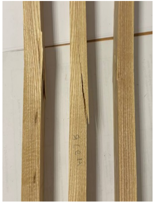
Рис. 3.9. Деформація зразків бересту під час згину
