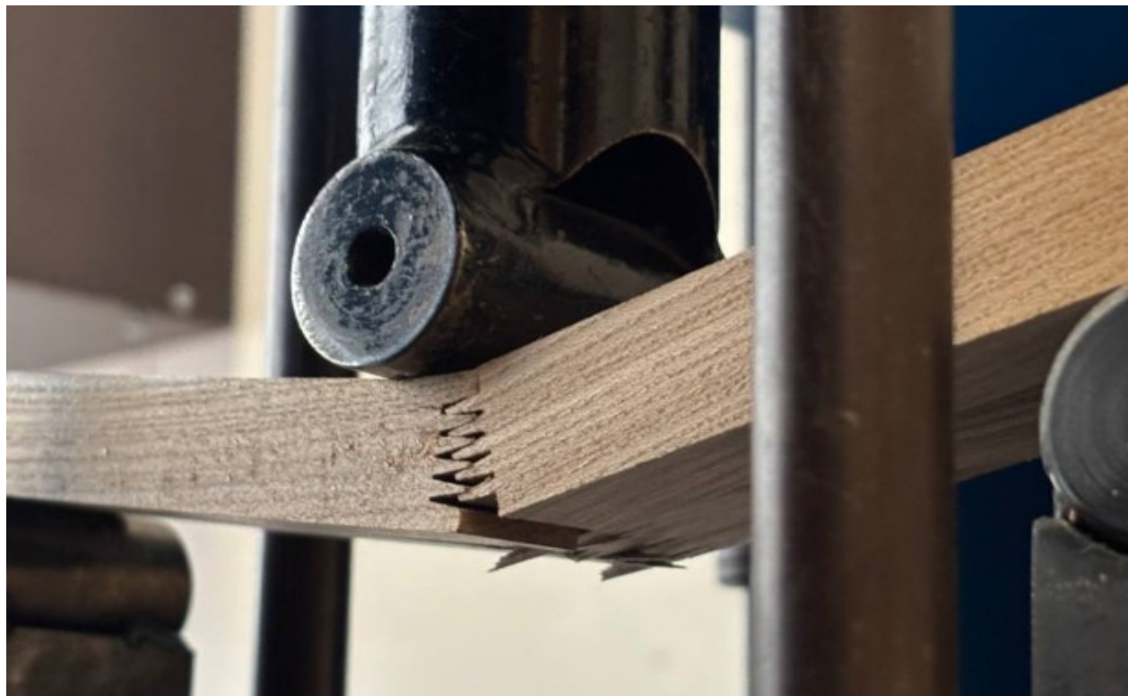
Рис. 3.7. Вплив навантаження на зразок бересту
