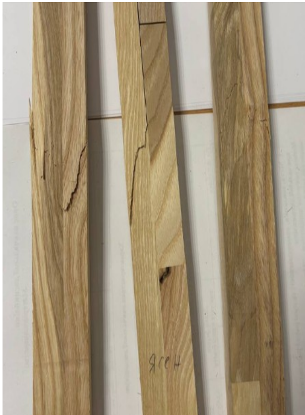
Рис. 3.9. Деформація зразків бересту під час згину
