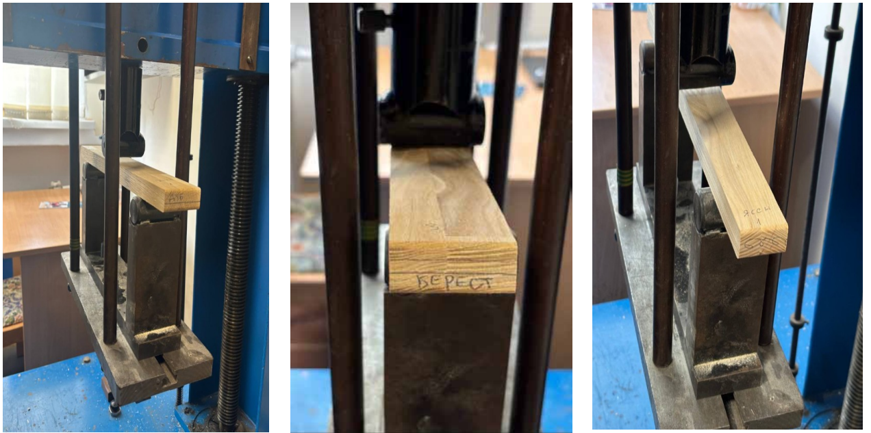
Рис. 3.3. Закріплення зразків для випробування на згин
