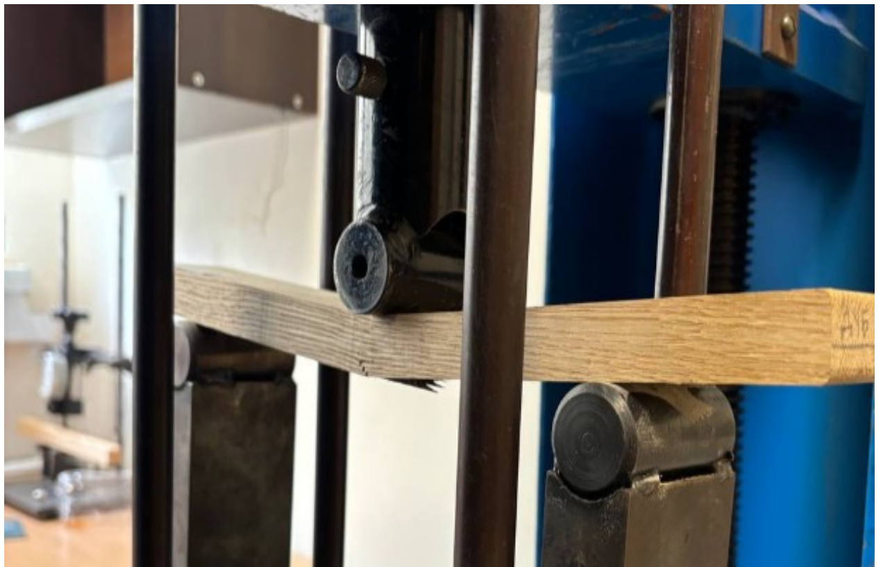
Рис. 3.4. Вплив навантаження на зразок дуба
