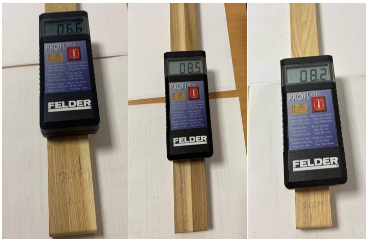
Рис. 3.2. Вимірювання вологості досліджуваних зразків деревини
