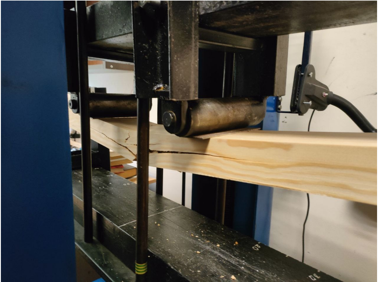
Рис. 3.5. Вигляд зразка після випробування
