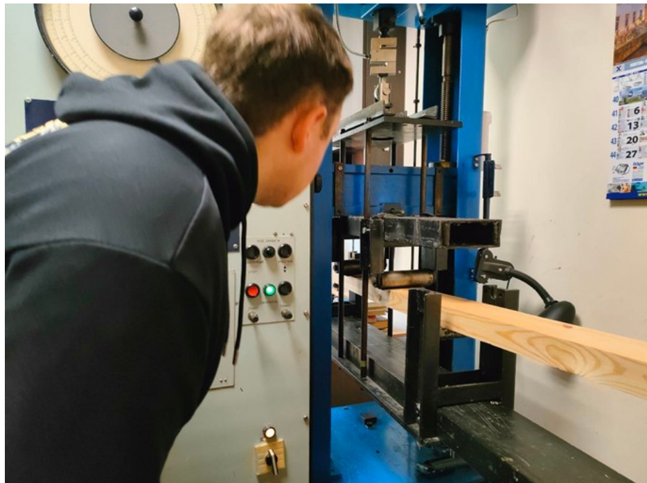
Рис. 3.3. Проведення випробування зразка деревини на машині
