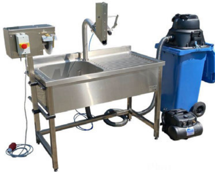
Рис. 3.3 Універсальний пристрій для переробки риби АГК
