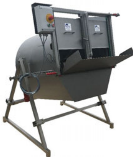
Рис. 3.2 Машину для зняття луски АГК-787.
