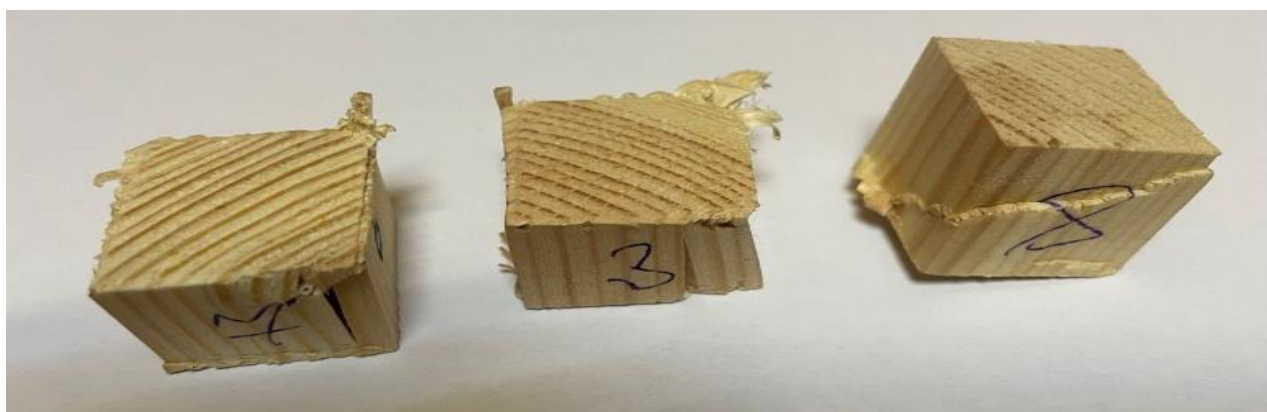
Рис 3.6. Деформація під час стиску
