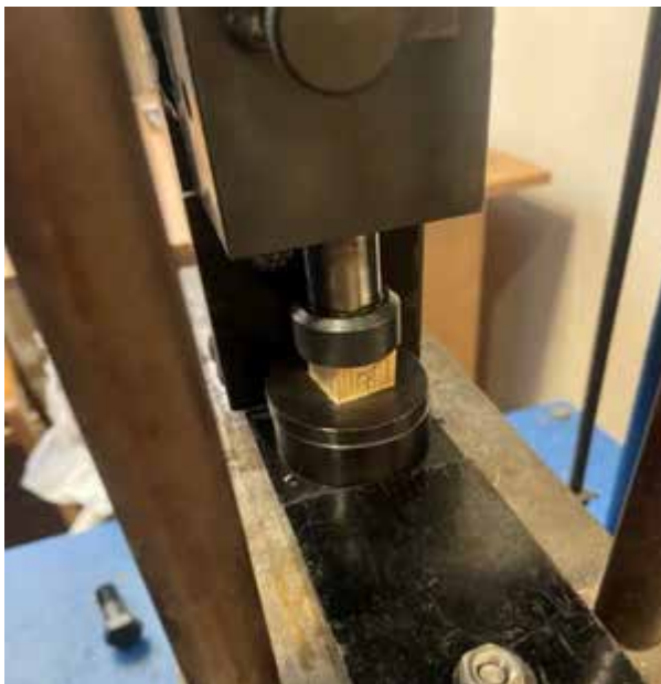
Рис. 3.4. Закріплення соснових зразків для випробування на стиск.
