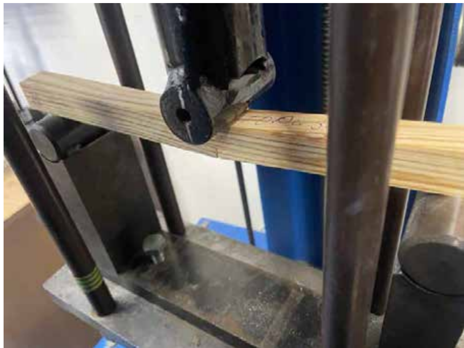
Рис. 3.11. Деформований зразок сосни після випробування
