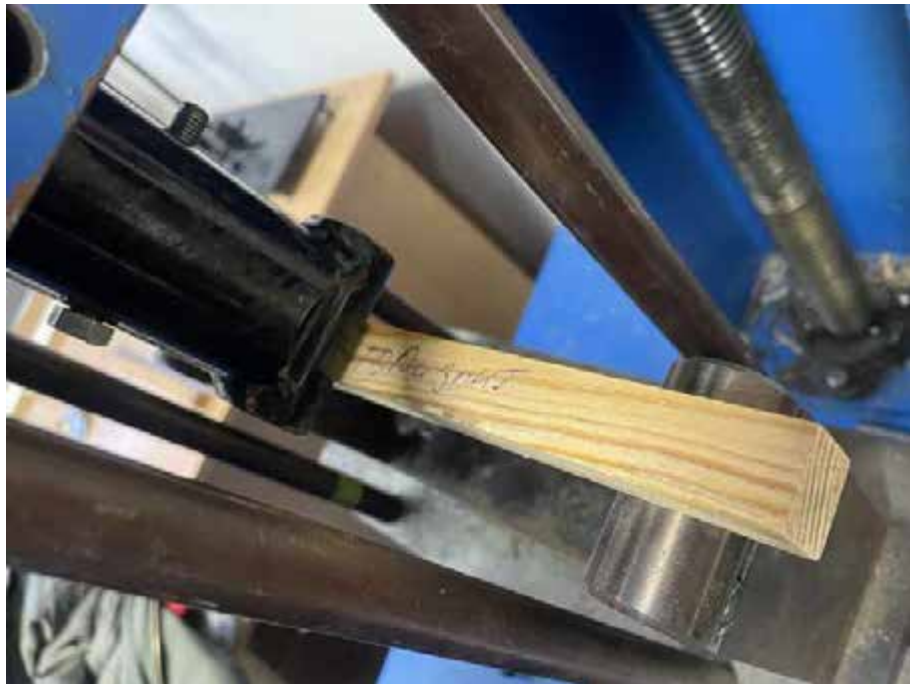
Рис. 3.10. Сосновий зразок на згин
