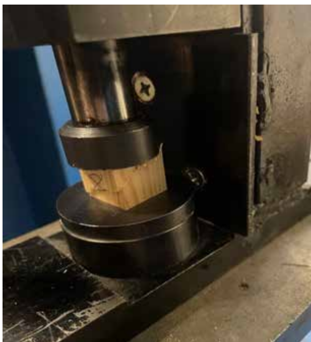
Рис. 3.5. Вплив навантаження на зразок
