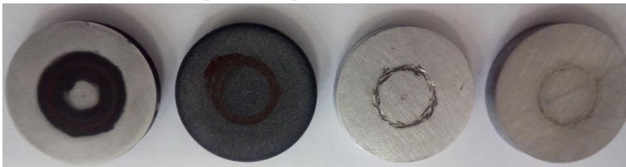
Рисунок 2.7 – Лабораторні зразки після випробувань на коефіцієнт тертя, де зліва направо: з ІЗ-покриттям, з МДО-покриттям, без покриття, із сталі 40Х.
