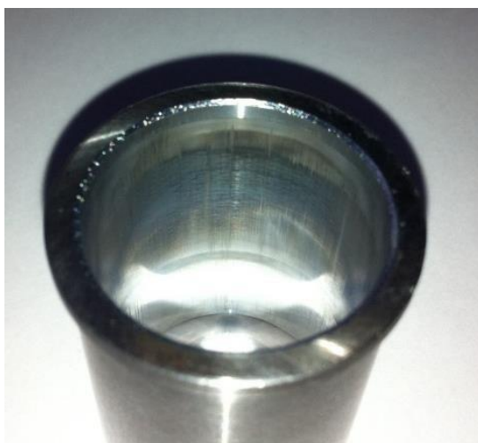
Рисунок 3.10 – Штатна гільза циліндра після випробувань
