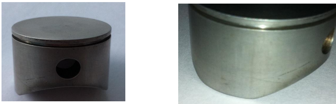
Рисунок 3.11 – Штатний поршень після випробувань
