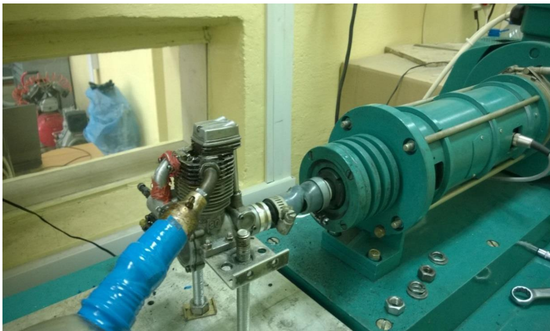
Рисунок 3.8 - Двигун на стенді СТМ-3000
