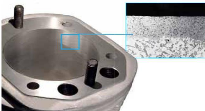
Рисунок 1.13 - Гільза циліндра з покриттям Nikasil [21]
