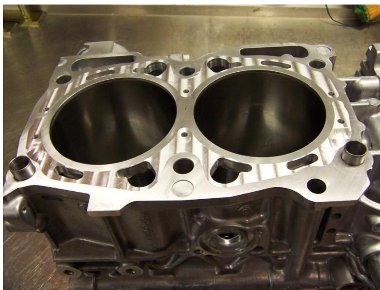
Рисунок 1.3 - Блоки циліндрів конструкції типу «Closed-Deck» [21]
