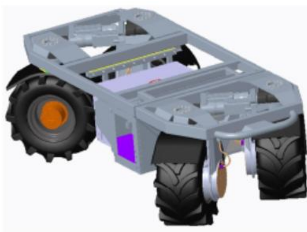
Рис.1.5. Система 4WD з незалежним керуванням кожного колеса
