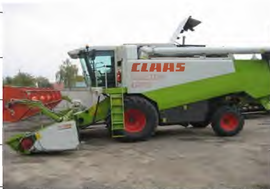
Рис. 2.5. Зовнішній вигляд зернозбиральної техніки господарства Комбайн Claas Lexion 450 оснащений гідростатичною трансмісією. Молотильний апарат складається з прискорювального барабана з
