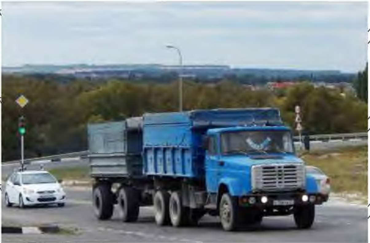
Рис. 2.8. Загальний вигляд автопоїзду ММЗ-4516 з причепом
