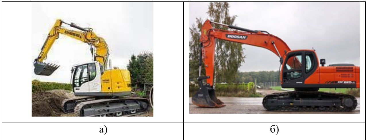
Рис. 1.6. Екскаватори: а) Liebherr R926; б) DOOSAN DX225
