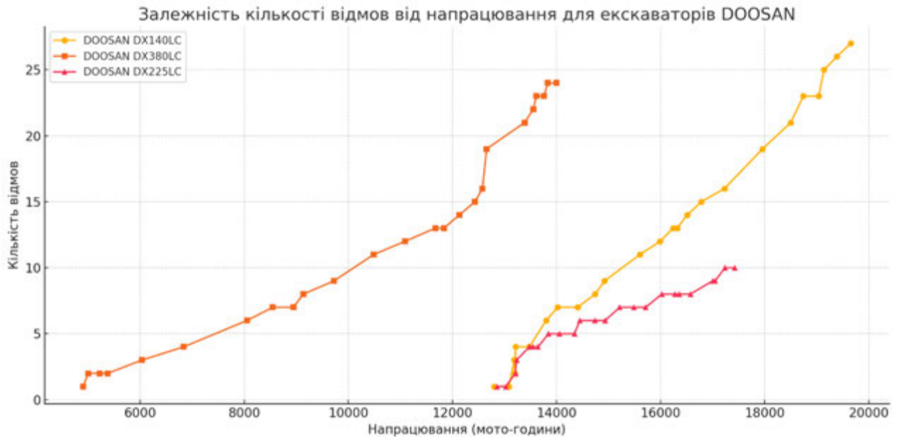
Рис. 3.2. Графік залежності кількості відмов від напрацювання екскаваторів DOOSAN
