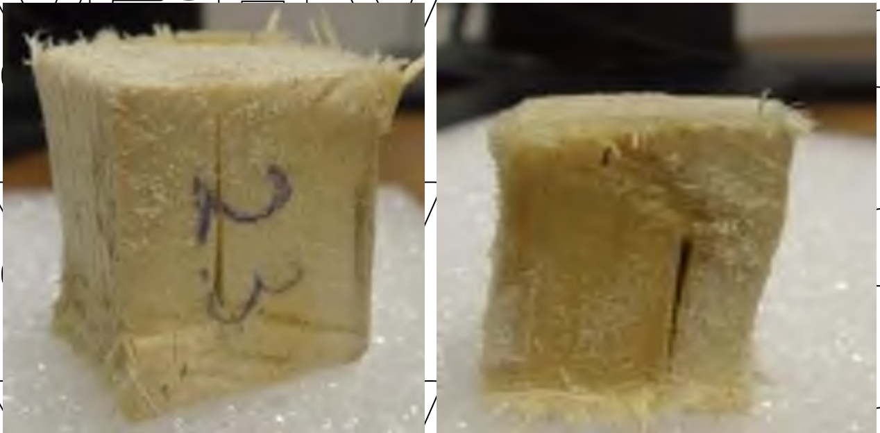
Рис. 3.8. Зразки сухостійної деревини сосни, зруйновані при стисканні
