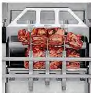
Рисунок 1.4 – Гільйотинні блокорізки: а) загальний вид Magurit Fromat, б) процес подрібнення м'яса на блокорізці Magurit Fromat;
