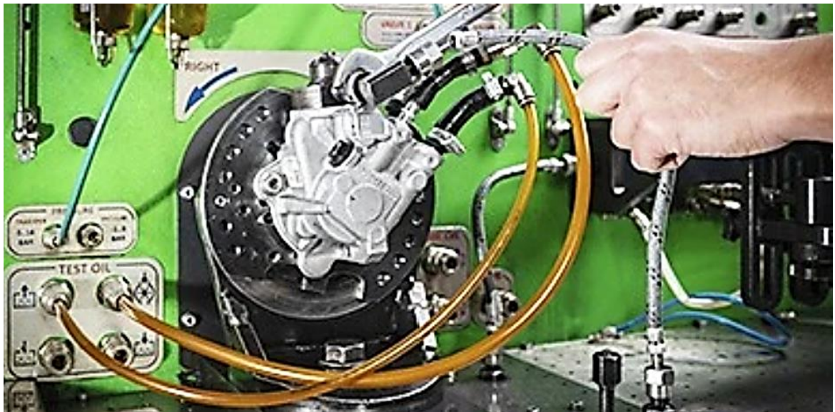
Рис. 3.4. Перевірка ПНВТ на діагностичному стенді
