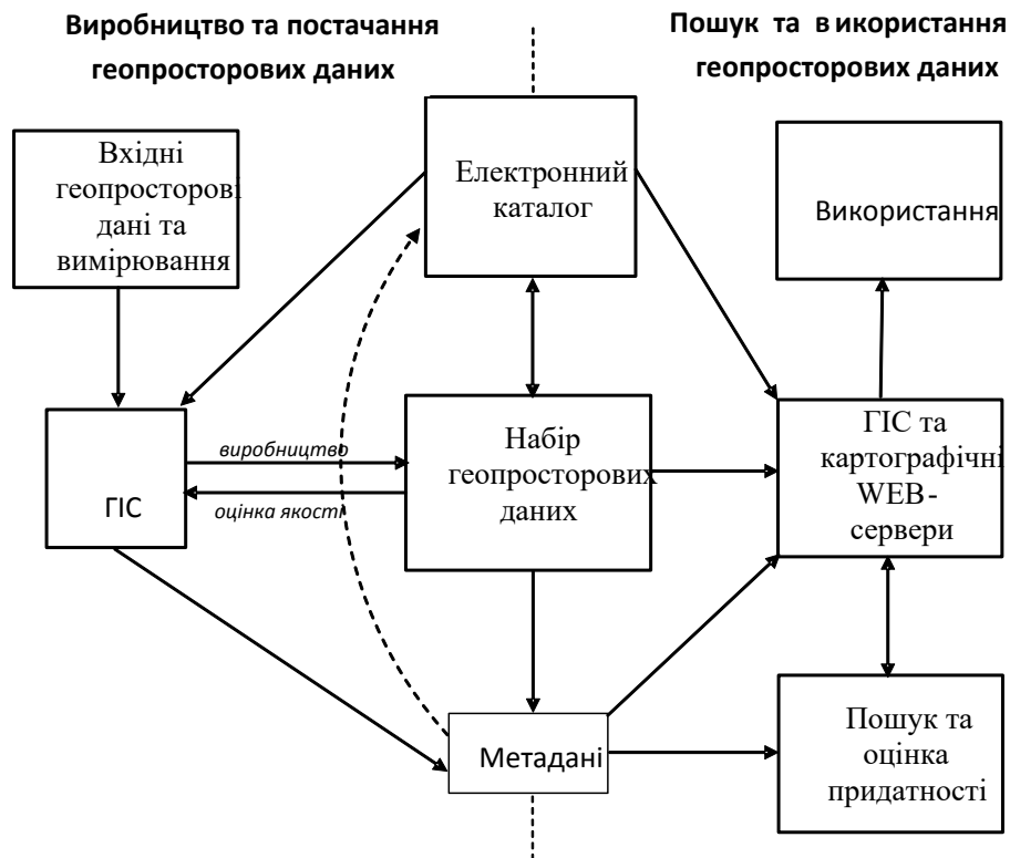
Рис. 2.3 Схема використання електронного каталогу в ГІС-застосунках
