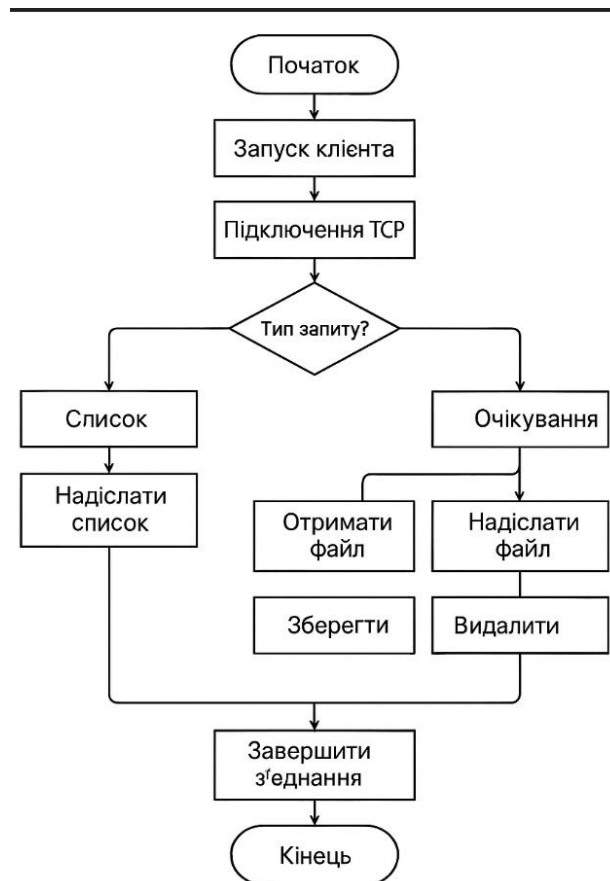
Рис. 2.6 – Діаграма активності модуля передачі файлів через TCP/UDP-протокол, реалізованого мовою Python
