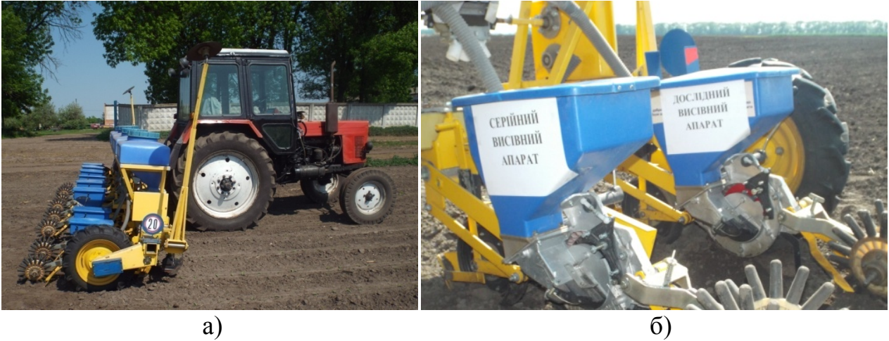
Рис. 14. Загальний вигляд: а – машинно-тракторного посівного агрегату (трактор МТЗ-80+сівалка СТВТ-12/8М); б – висівні секції для проведення порівняльних досліджень роботи експериментального висівного апарата в польових умовах.
