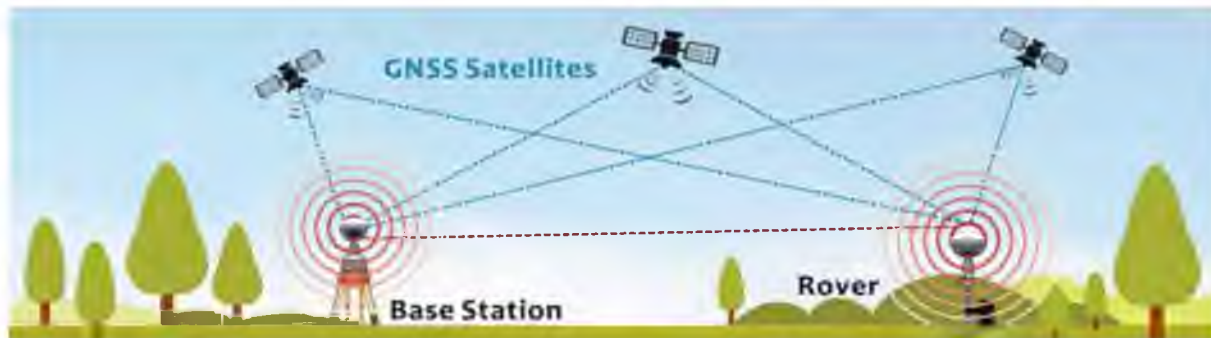
Рис. 2 Ілюстрація принципу роботи високоточної системи орієнтації в просторі RTK
