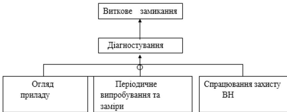
Рис.2.13 - Структурна схема визначення необхідності діагностування виткових замикань обмоток трансформатора 6–10/0,4 кВ
