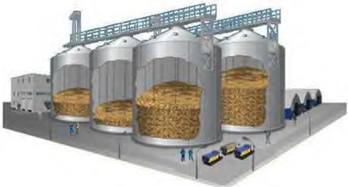
Рис. 2.2. Зовнішній вигляд одного із силосів Катеринопільського елеватора (а) та схематичні розрізи силосів з різним ступенем заповнення зерном
