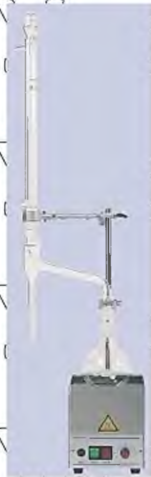
Рис. 3.6 - Установка для визначення складу води в оливі
