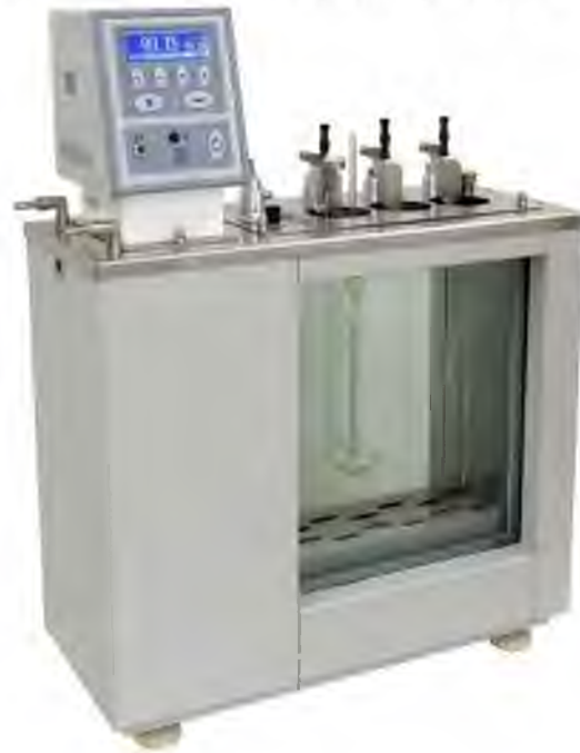
Рис. 3.7 - Термостат рідинної ВІС-Т-03 для визначення кінематичної в'язкості нафтопродуктів типу ВПЖ -2 або ВПЖ-4
