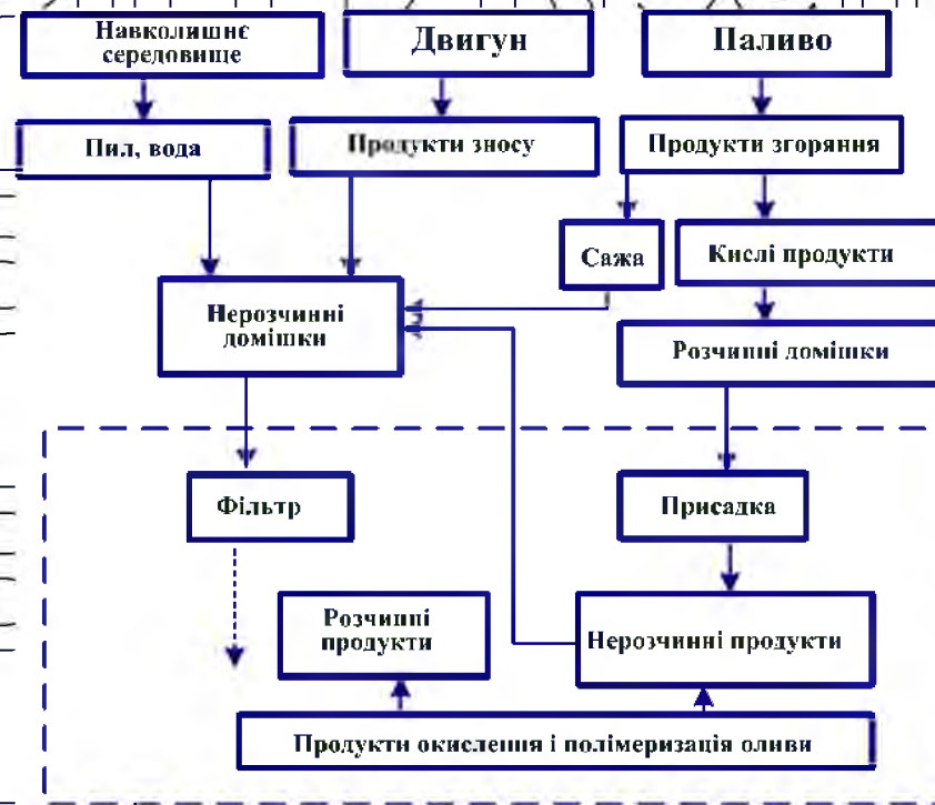
Рис. 1.4 - Схема забруднення оливи при роботі дизеля
