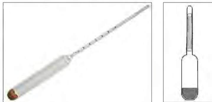
Рис. 3.5 - Ареометр АН - для визначення щільності моторних олив
