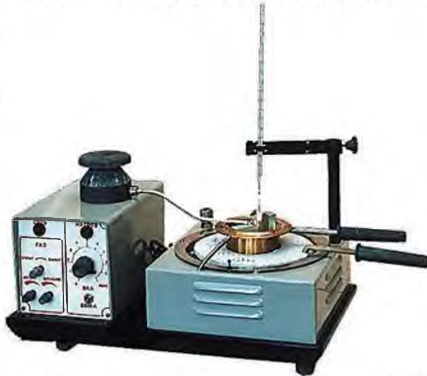
Рис. 3.2 - Установка для визначення температури спалаху у відкритому тиглі типу ТВС
