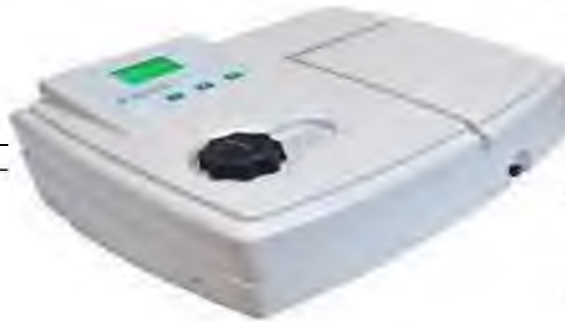
Рис. 3.3 - Установа для вимірювання забрудненості оливи спектрофотометр
