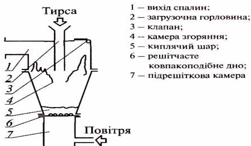
Рис. 2.6. Флюїдальна піч для спалювання відходів деревини
