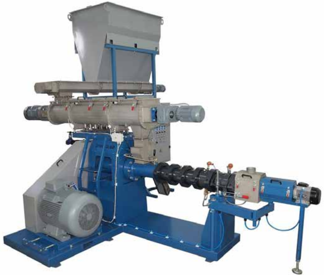
Рис. 1.2. Одношнековий екструдер для виготовлення пелет
