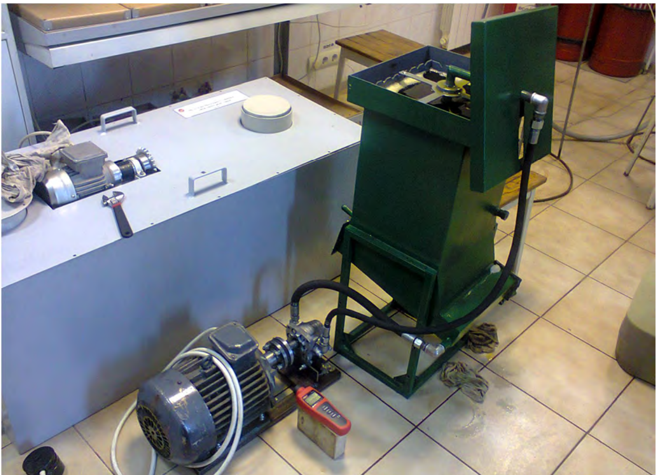
Рис 3.9. Експериментальна установка для естерифікації ріпакової олії в дизельне біопаливо
