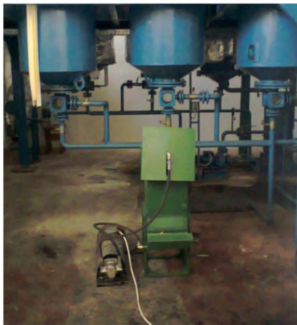
Рис. 5.2. Виробнича установка для виробництва дизельного біопалива з використанням гідромеханічного перемішування
