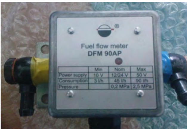
Рис. 3.31. Електроні витратоміри палива на базі датчика DMF-90
