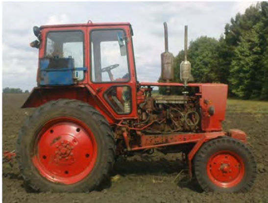
Рис. 3.25. Трактори ПМЗ-6АКЛ та Кий-14102 обладнаний системою двохступеневого підігріву палива
