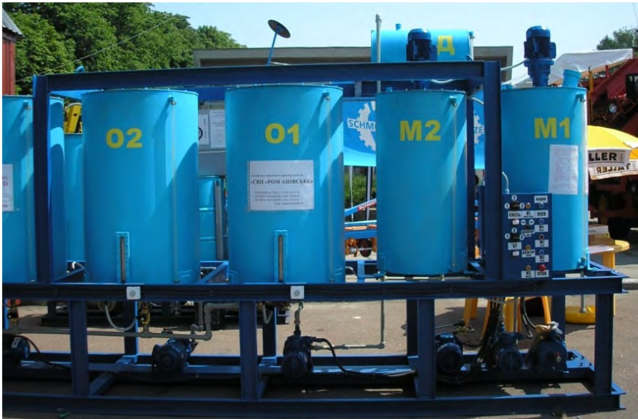
Рис. 1.9. Установка для одержання дизельного біопалива з рослинних олій продуктивністю 1000 т/рік УВМЕ-100
