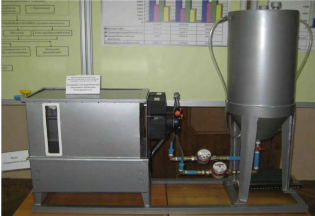
Рис. 1.10. Обладнання для виробництва дизельного біопалива УБ-ТР-20 продуктивність 5 л/год.
