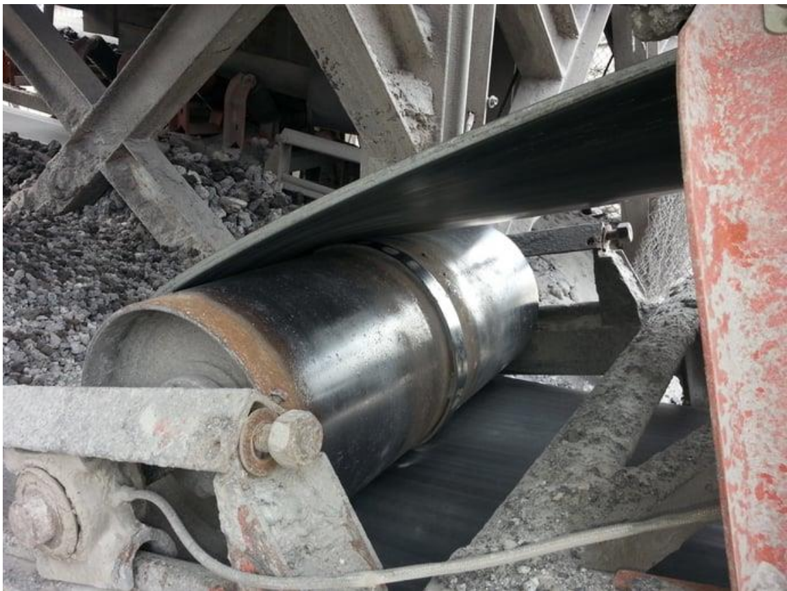
Рис. 1.2. Стрічки розроблені з мінімальним розміром барабана, визначеного виробником
