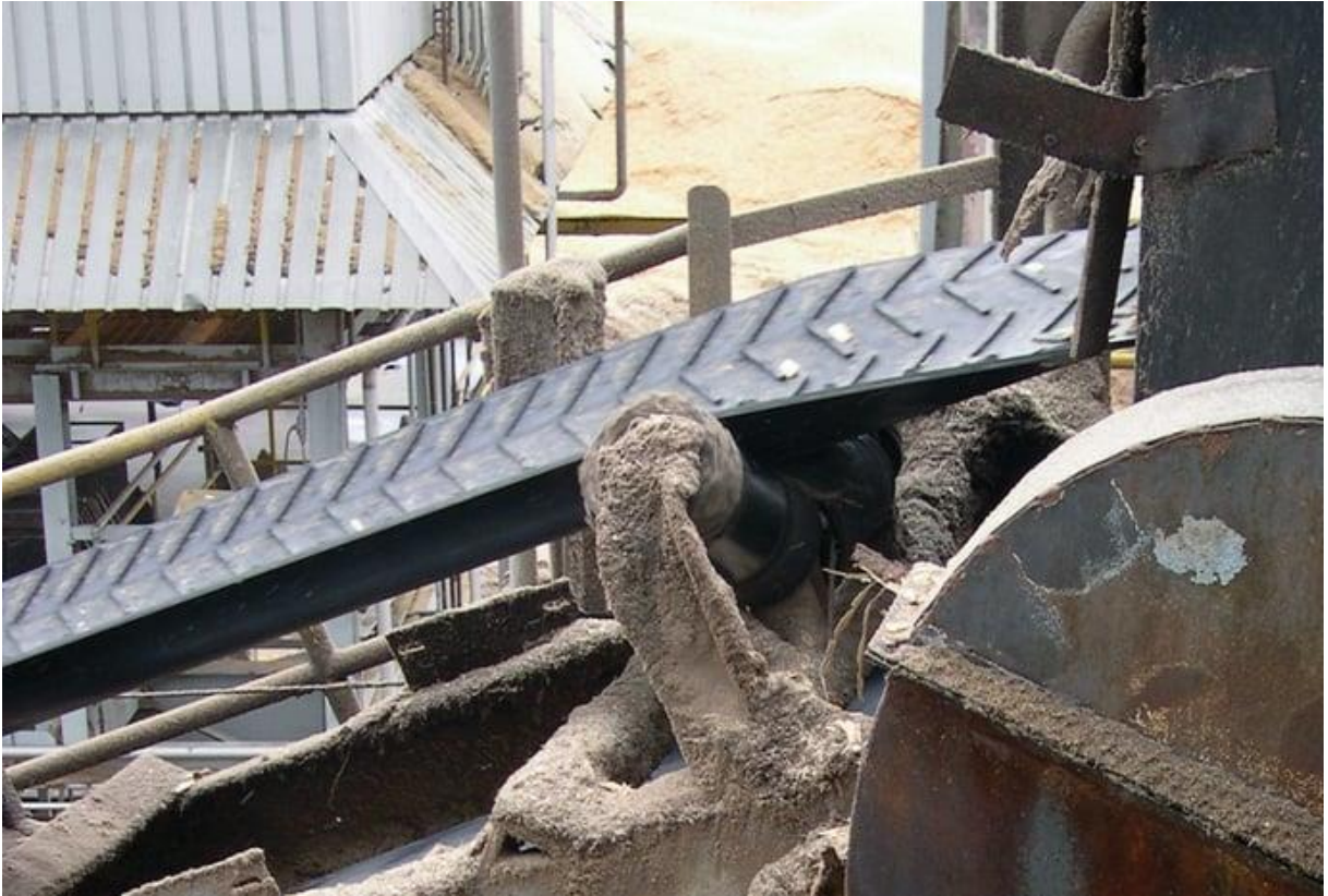
Рис. 1.1. Підвищення ефективності конвеєрної стрічки за допомогою рельєфних елементів
