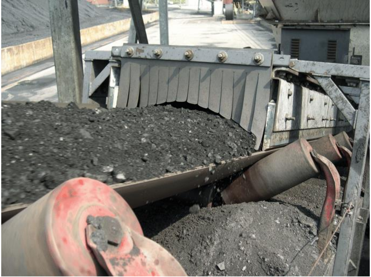
Рис. 1.7. Траспорування вугілля трироликовою опорою
