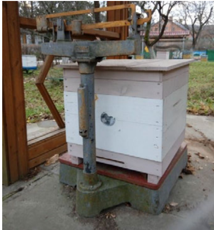
Рис. 2.7. Платформові ваги для зважування вуликів
