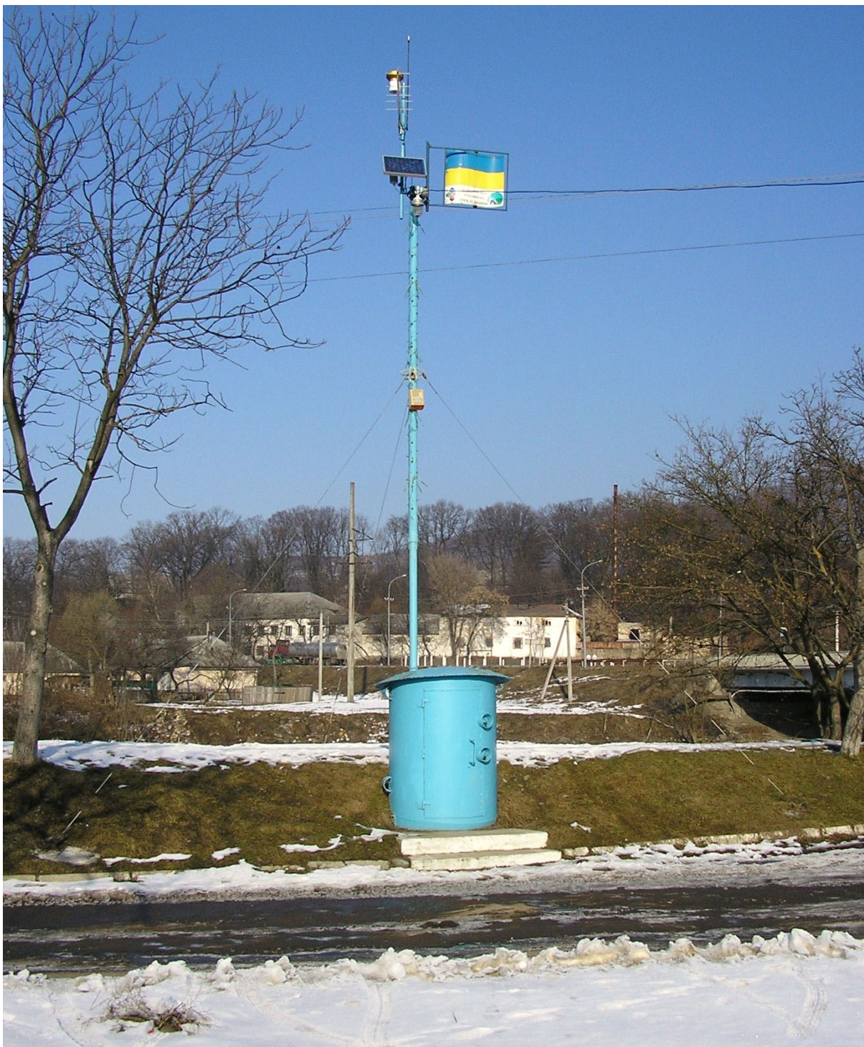
Світлина 3.1. Автоматичний гідропост на р. Латориця (м. Свалява). Світлина В. Шушняка.
