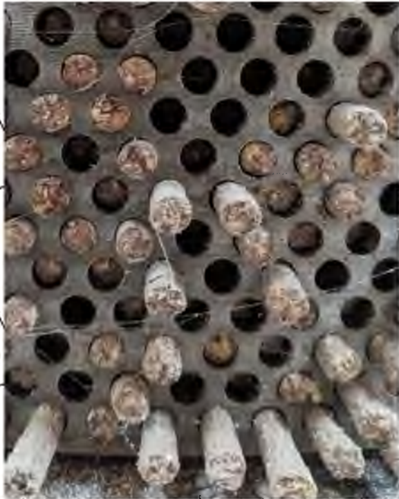
Рис. 2.5. Матриця гранулятора на 4 мм Джерело: сформовано автором.
