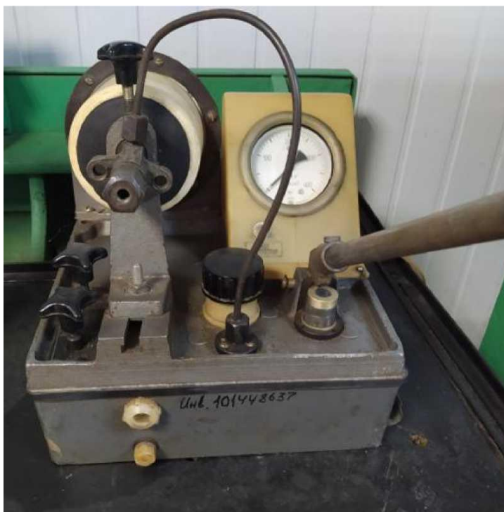
Рис. 3.6. Настроювання гідроаккумулятора експериментальної установки на приладі КИ 15706
