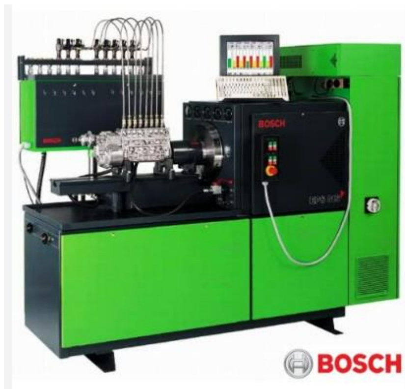
Рис. 3.7. Контрольно - регулювальний стенд «Bosch» для безмоторних досліджень плунжерних пар
