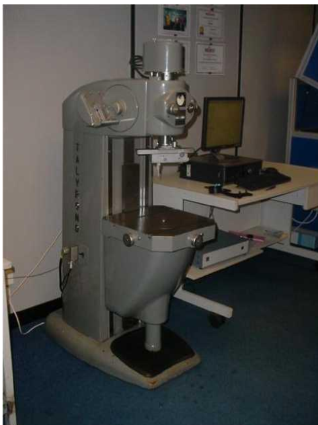
Рис. 3.1. Профілограф «Talyrond» для дослідження мікрогеометрії плунжерних пар
