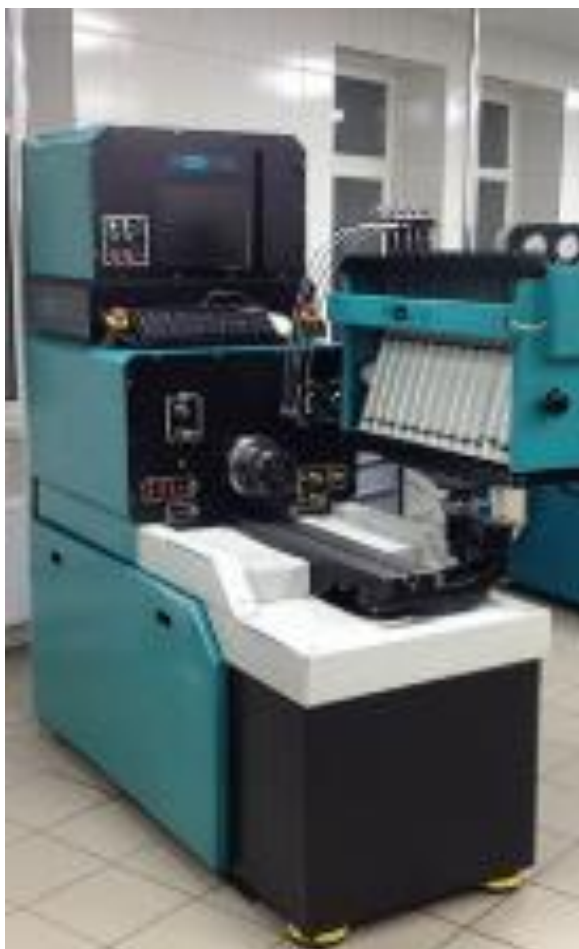
Рис. 3.3. Прилад PVLTESTER 712A для випробувань плунжерних пар на гідрощільність.
