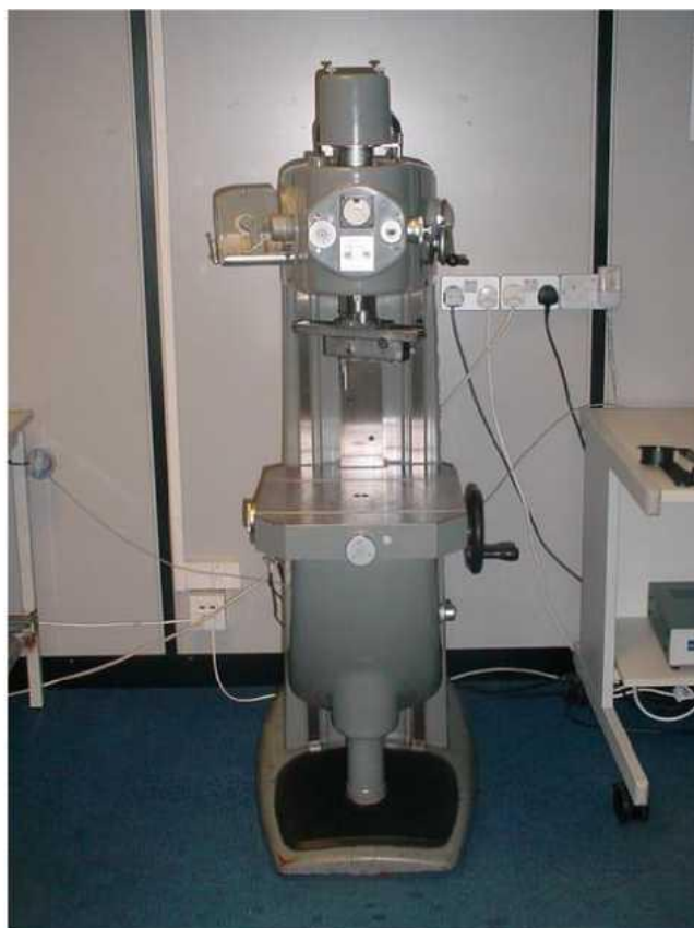
Рис. 3.1. Профілограф «Talyrond» для дослідження мікрогеометрії плунжерних пар
