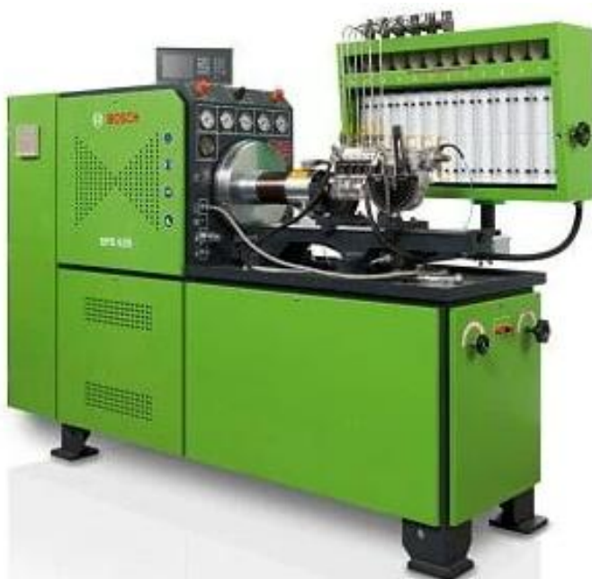
Рис. 3.4 Установка для дослідження імпульсу тиску палива, встановлена на стенді «EPS 625».
