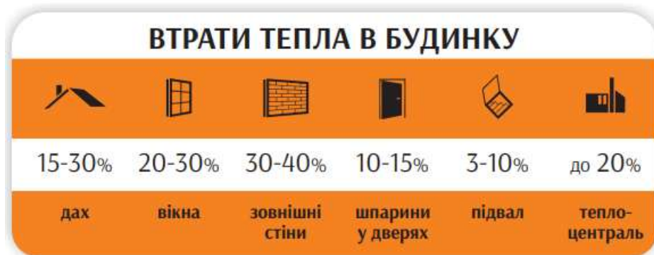
Рис. 3.1. Втрати теплоти в будівлі
